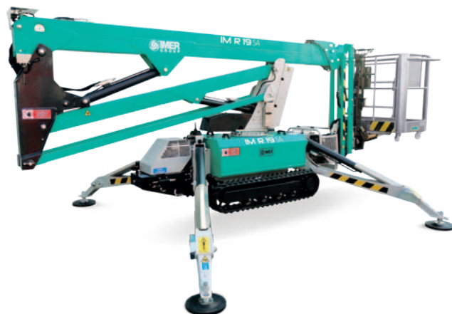
Tamaño compacto, con una huella general limitada de los estabilizadores. La estabilización automática estándar permite un posicionamiento óptimo y rápido de la máquina.
