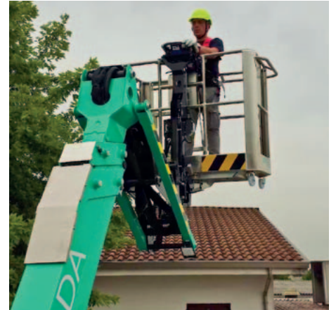
Jib hidráulico activo y rotación de la cesta \pm 62^\circ : colocación completa en el lugar de trabajo en cualquier condición.
