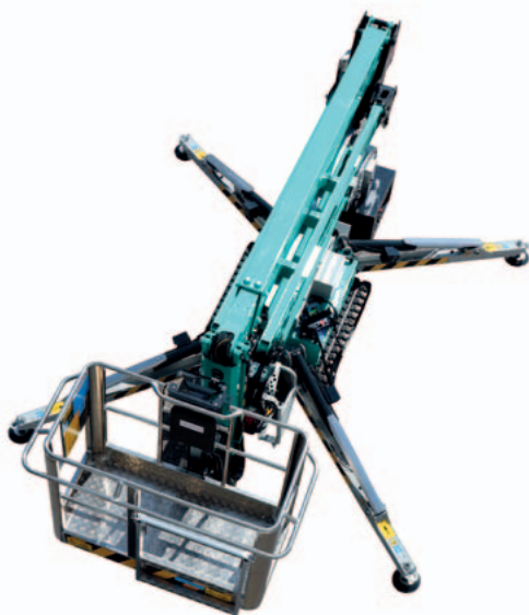
Estabilización de 45 ° en una posición general limitada de los estabilizadores.
