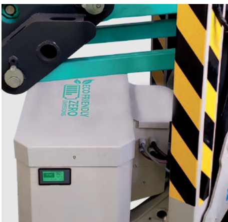
Compartimento para las baterías de litio: protegido y de fácil acceso para la gestión del ciclo de carga. Pantalla LCD para el estado de carga y el tiempo restante de la batería (IM R 15 DA Lithium).
