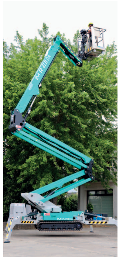
Brazo de doble articulación con sección telescópica y Jib hidráulico para garantizar una excelente maniobrabilidad y posicionamiento.
