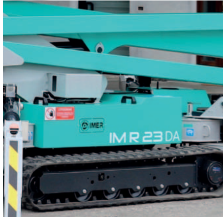
Ancho de oruga ajustable hidráulicamente: más estabilidad y tracción para moverse por la obra o terreno accidentado.
