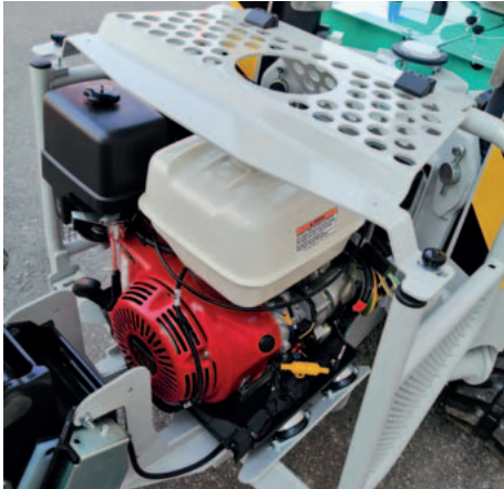
Motor protegido por una estructura robusta que evita daños en caso de caída de material.
