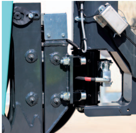
Conjunto del brazo compacto, que aloja la celda de carga y la rotación de la cesta.
