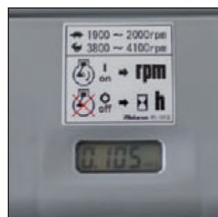
Contador de horas y revoluciones del motor.
