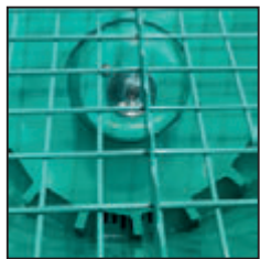
Nuevo diseño de la noria giratoria con celdas más grandes, para un mayor acopio de los materiales. La noria es el elemento que impulsa los materiales hacia la bomba de camisa y eje sinfín.
