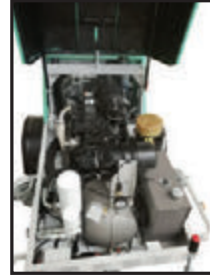
Motor Diésel Yanmar de 35 Kw, 4 cilindros. Acoplamiento directo motor a compresor
