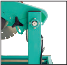
Sistema de regulación del brazo mediante un perno especialmente estudiado y patentado IMER. Un selector fácilmente accionable, fija la altura de corte necesaria tanto para el disco de 350 mm de Ø como para el disco de 400 mm de Ø.
