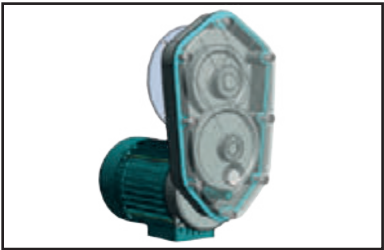
El motor-reductor patentado IMER con ejes paralelos, permite transferir la potencia del motor con una mínima pérdida de la fuerza motriz. La particular configuración del motor-reductor colocado debajo de la tolva, reduce el tamaño de la máquina y a su vez lo protege de los golpes y de los ambientes polvorientos de las obras.
