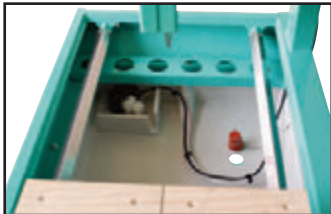
Con guías para el carro en acero inoxidable. Bomba de agua protegida para sedimentos. Higiénica cubeta de plástico desmontable para su limpieza, con decantación para atrapar los sedimentos.
