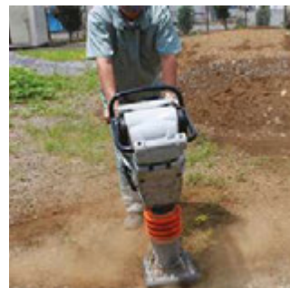
Protección integral del motor con carcasa ABS.
