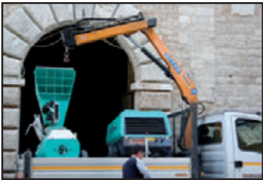
Equipos para bombeo, (transportadora más compresor), sobre un pequeño furgón abierto, que permite fáciles, ágiles y económicos traslados de obra en obra
