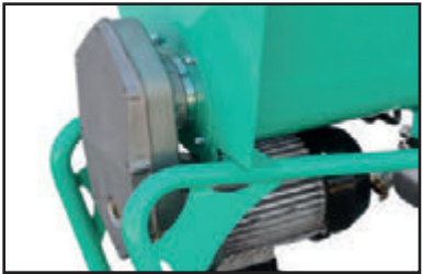
Transmite la potencia del motor a las palas de mezcla mediante un reductor con engranajes de acero tratado inmersos en baño de aceite. Con este sistema directo de transmisión, se garantiza unas prestaciones más elevadas, eliminándose las típicas averías que se producen por el sistema de transmisión de la potencia mediante correas.
